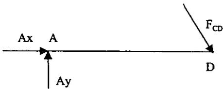
Figura 9.- Diagrama de cuerpo libre del eslabón AD
