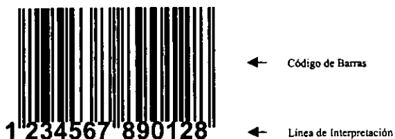
Fig. 1 Componentes básicos de un código de barras
