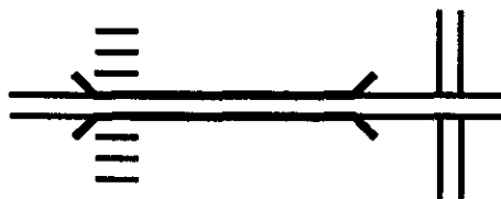
Fig. 38 Paso a Desnivel
