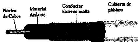
Figura 4.2. ESTRUCTURA DEL CALBLE COAXIAL BELDEN RG-58A/U.
