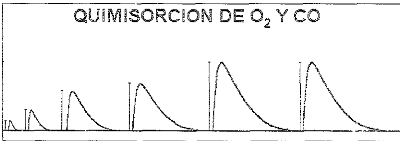
Figura 3.2.2.- Curvas de saturación para quimisorción de moléculas sonda sobre catalizador Ni/\gamma-Al_2O_3 con O_2 y CO como gases reductores.
