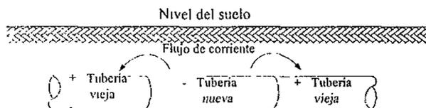
Fig. 6.58 Corrosión electroquímica por tubería nueva.
