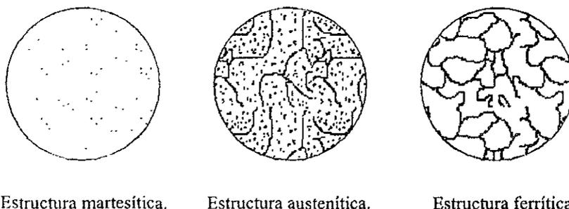
Fig. 4.1 Estructuras cristalinas de los aceros.
