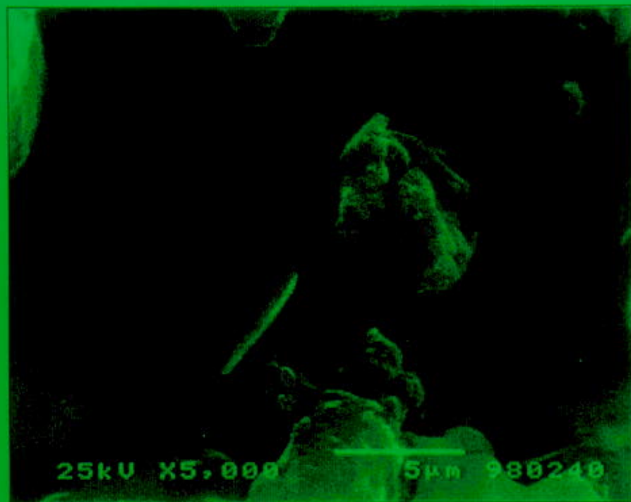
Figura IV.13. Microscopía electrónica de barrido para suelo tratado con óxido de calcio al 8% en peso sin envejecer.
