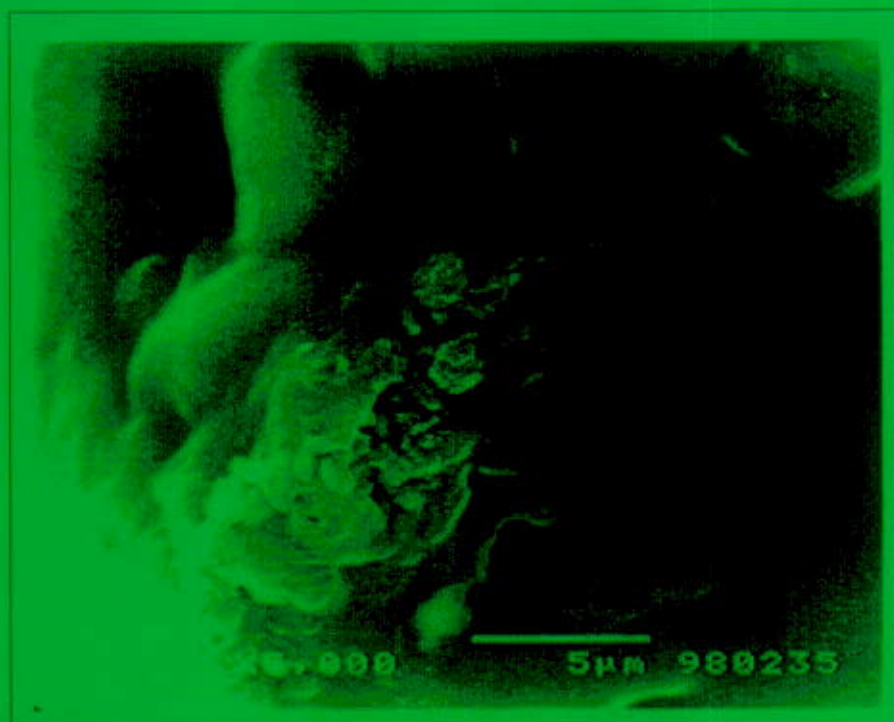
Figura IV.14. Microscopía electrónica de barrido para suelo tratado con óxido de calcio al 8% y envejecido 5 años de forma natural.
