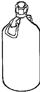
Figura 5.2 b) Bidón de plástico con tapa fija, tipo no apilable. (Capacidad nominal de 20 a 60 litros) (NOM-024-SCT2/94)
