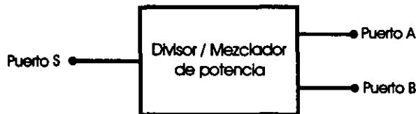
Figura 4-6 Divisor de potencia básico
