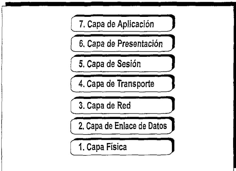
FIGURA 1.6. CAPAS DEL MODELO OSI
