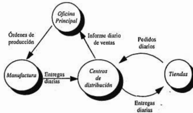
Figura 4.11 Sistema de manufactura integrada en Industrias Kao
