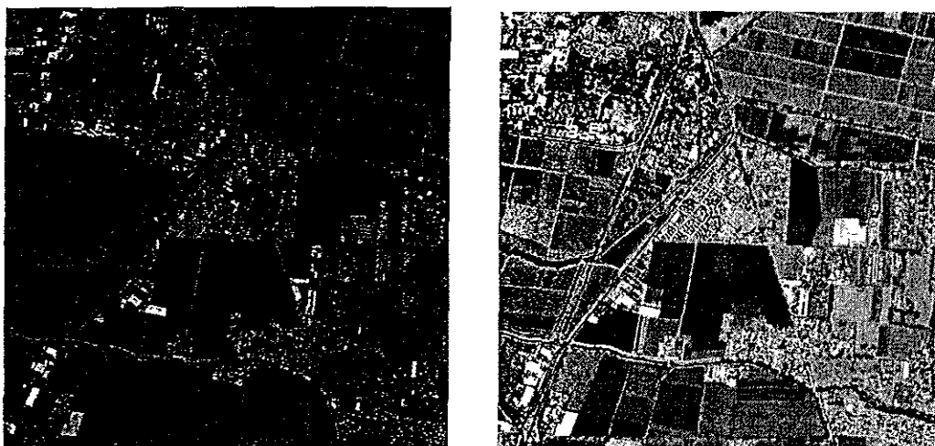
Figura 1.3 Segmento de una fotografía aérea digital antes (izq.), y después de su mejoramiento (der.) dentro del procesador de imágenes. Dicho proceso consistió en el ajuste del histograma de la curva RGB de cada imagen en el software procesador de imágenes.
