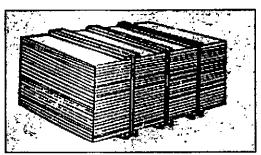
11) Balona: conjunto ordenado de láminas protegidas por tarimas de madera flejadas con cintas de plástico y acero. El cartón, el hierro y el corcho son productos laminados que se manejan fácilmente en forma de balona.
