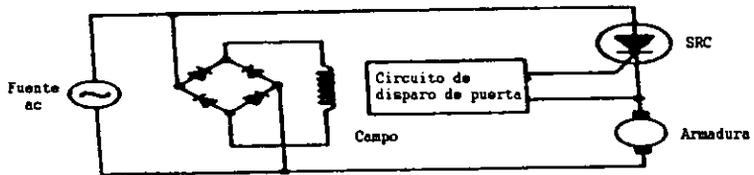
Fig. 13 Un SCR en serie con la armadura para controlar la velocidad del motor.
