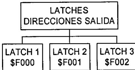
Fig. 52 Direcciones de Salidas
