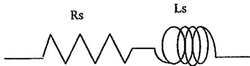
Figura 3.6. Esquema del circuito equivalente que representa el proceso de la permeabilidad inicial
