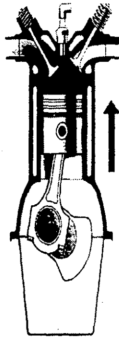
4. Tiempo de escape. La válvula de escape permanece cerrada y en ella se abre el escape. El pistón sube y empuja los gases hacia afuera, cerrando un nuevo ciclo.
