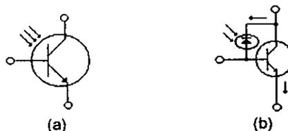
Fig. 1.10 a) símbolo electrónico b) circuito equivalente
