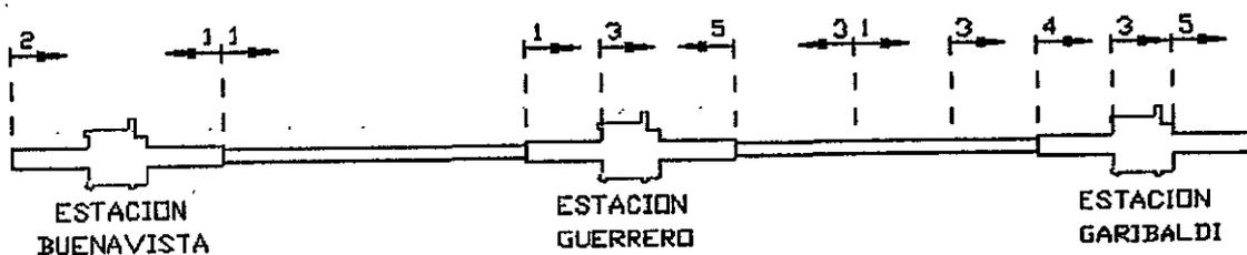
**Figura II.2.c.- Estrategia de ataque de excavación.**
