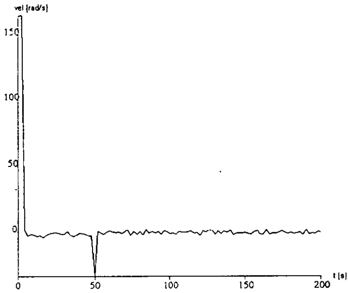
Figura 5.6: Error de velocidad en el controlador en lazo cerrado.
