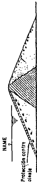
Presa de relleno hidráulico Figura 3.2
