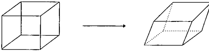
Fig. (4).- Deformación de corte simple en un sólido.
