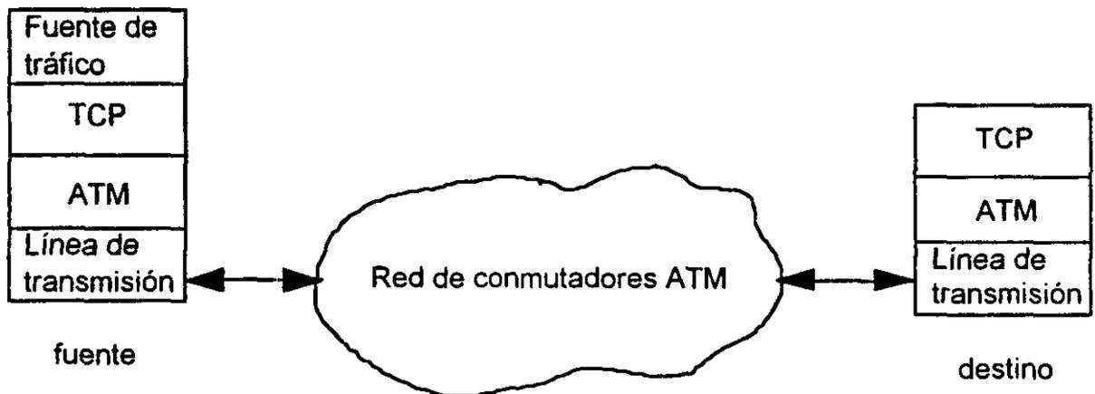
Figura 4.1 Arquitectura de capas del modelo de simulación
