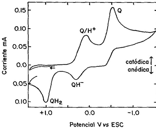
**Figura 2.2** Voltamperograma cíclico de 1,4-benzoquinona  $1.52 \cdot 10^{-3}$  M en presencia de ácido perclórico  $1.91 \cdot 10^{-3}$  M, en perclorato de tetraetilamonio 0.01 M en acetonitrilo, velocidad de barrido 0.12 V/s.<sup>124]</sup>
