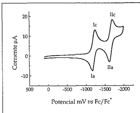
**Figura 4.1** Voltamperograma cíclico de ANQ 1 mM en  $\text{Et}_4\text{NBF}_4$  0.1M en acetonitrilo. Electrodo de trabajo : Pt. Velocidad de barrido : 100 mV/s.
