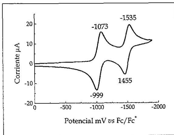
**Figura 4.2** Voltamperograma cíclico de NQ 1 mM en Et<sub>4</sub>NBF<sub>4</sub> 0.1M en acetonitrilo. Electrodo de trabajo : Pt. Velocidad de barrido : 100 mV/s.
