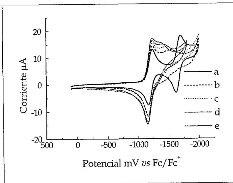
**Figura 4.13** Voltamperogramas cíclicos de a) ANQ 1mM en Et<sub>4</sub>NBF<sub>4</sub> 0.1 M en acetonitrilo y ANQ 1 mM en presencia de concentraciones crecientes de fenol: b) 1.0 mM; c) 1.5 mM; d) 2.0 mM y e) 2.5 mM. Electrodo de trabajo Pt. Velocidad de barrido: 100 mV/s.
