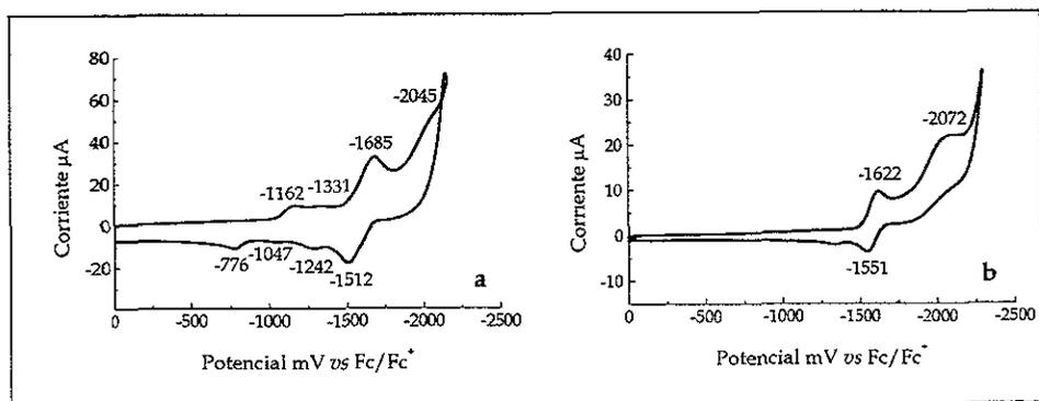
**Figura 4.4** Voltamperogramas cíclicos de a) *m*-NO<sub>2</sub>ANQ, 0.35 mM ; b) *m*-nitroanilina 0.2 mM en Et<sub>4</sub>NBF<sub>4</sub> 0.1M en acetonitrilo. Electrodo de trabajo : Pt. Velocidad de barrido : 900 mV/s.
