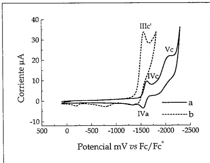
**Figura 4.18** Voltamperograma cíclico de *m*-nitroanilina 0.2 mM en  $\text{Et}_4\text{NBF}_4$  0.1 M en acetonitrilo a) en ausencia de fenol y b) en presencia de fenol 6.5 mM. Electrodo de trabajo Pt. Velocidad de barrido 100 mV/s.
