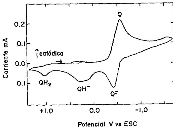
Figura 2.1 Voltamperograma cíclico de 1,4-benzoquinona  $1.87 \cdot 10^{-3}$  M en presencia de ácido benzoico  $2.3 \cdot 10^{-3}$  M, en perclorato de tetraetilamonio 0.01 M en acetonitrilo, velocidad de barrido 0.12 V/s.<sup>[24]</sup>
