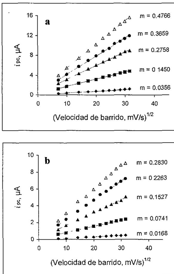
**Figura 4.19** Comportamiento de la corriente de pico catódico respecto a la velocidad de barrido, para ANQ (♦) 0.5 mM, (■) 1.0 mM, (▲) 2.0 mM, (●) 3.0 mM y (△) 4.0 mM, **a**) en presencia de fenol 6.5 mM y **b**) en ausencia de fenol.
