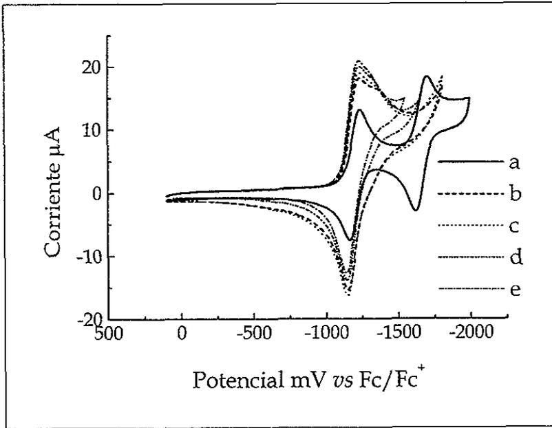
**Figura 4.14** Voltamperogramas cíclicos de a) ANQ 1mM en Et<sub>4</sub>NBF<sub>4</sub> 0.1 M en acetonitrilo y ANQ 1 mM en presencia de concentraciones crecientes de fenol: b) 3.0 mM; c) 3.5 mM; d) 4.0 mM y e) 4.5 mM. Electrodo de trabajo Pt. Velocidad de barrido: 100 mV/s.
