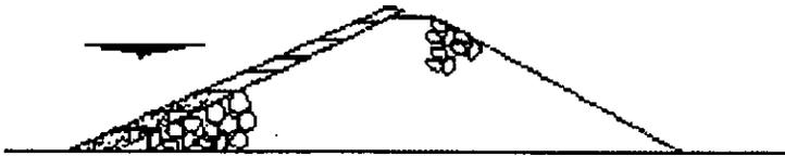
**(d) Enrocamiento con pantalla de concreto**
