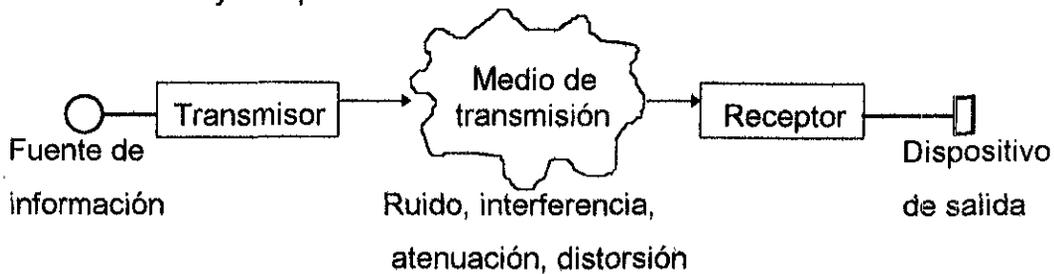
**Figura # 1 Diagrama de bloques de un sistema de comunicaciones punto a punto**
