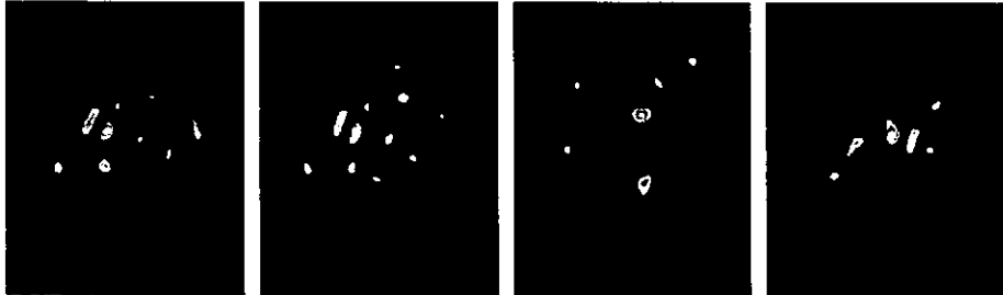
Figura (3.1) Estas imágenes son de una estrella, y muestra como la turbulencia atmosférica degrada la calidad de la imagen la cual aparece como un punto de luz difuso.
