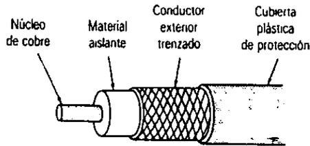
FIGURA 2.6 Corte de un cable coaxial.
