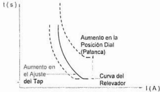
Fig. 6.2 Ajusto Tiempo-Corriente de Relevadores
