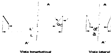
Fig. 38. Medidas necesarias para especificar el contorno geométrico del tundish.
