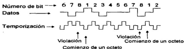
Figura 7/G.703 Estructura de las señales en los accesos de salida de datos para el interfaz contraridireccional a 64 Kbps.
