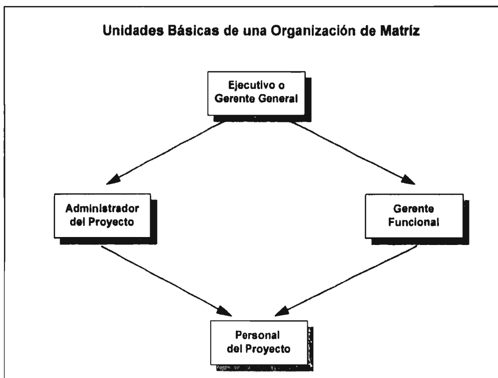
Figura 5-2. Elementos básicos de una organización matricial. Fuente: Linn C. Stuckenbruck, "The Implementation of Project Management", 1985, p. 70.
