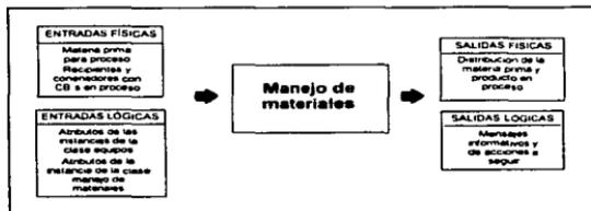
Figura 4.10 Esquema lógico del manejo de materiales.
