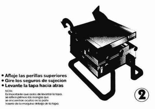
Sujete los seguros de sujeción con las perillas del cuerpo superior
