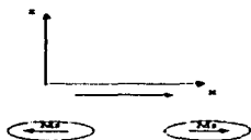
Fig. 1.14 Partícula monodominio elongada con anisotropía de forma uniaxial. Sólo dos estados estables son posibles, como se muestra, es decir, paralelo o antiparalelo al eje fácil
