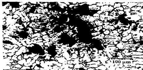
Figura 21. Microestructura del compuesto sin tratamiento de refinación, mostrando la distribución e incorporación de SiCp en la matriz, obtenida por MO.
