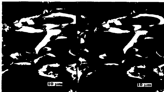
Figura 22. Microestructura del compuesto sin tratamiento de refinación, mostrando el mapeo elemental de Ti, obtenida por SEM.
