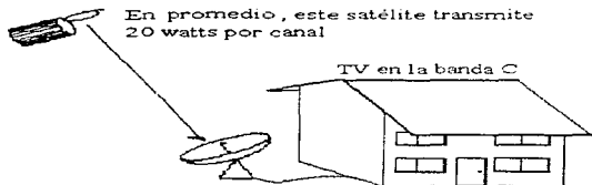
a) Antena más equipo electrónico que funciona con frecuencias en la banda C
