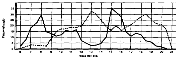
fig. 4.14 Gráfica con el flujo de pasajeros típico en el equipo de transporte vertical de un edificio.
