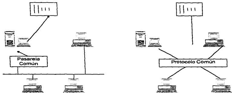
Figura 5. Modelos cliente-servidor con protocolo y pasarela común.
