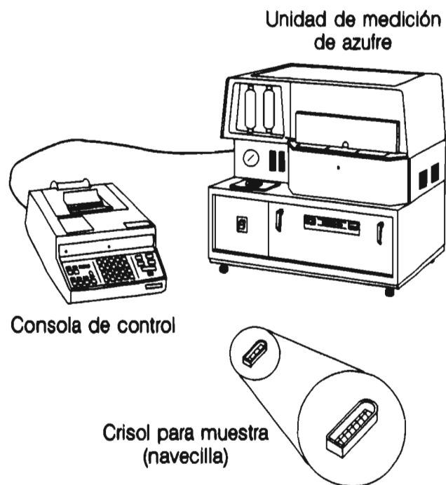
Figura 16 Equipo de marca Leco SC32 para medición del porcentaje de azufre en peso.
