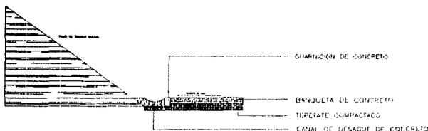
DETALLE DE CANAL PARA ESCURRIMIENTOS DE TALUD
