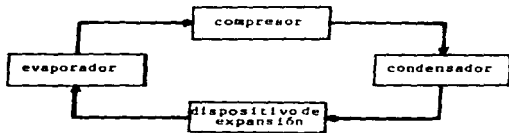
Fig. 4.1. Sistema termodinámico de bloques de un refrigerador.
