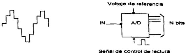
Figura IV.5. Convertidor analógico a digital (A/D).
