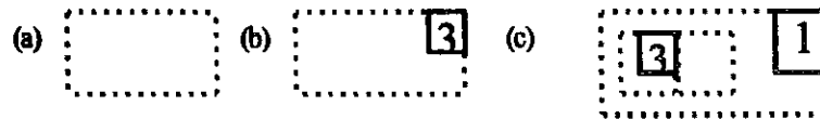
FIGURA 4.6. Grupos. (a) grupo; (b) grupo con indicador n; y (c) grupo recursivo.
