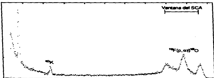
Figura 1.9. Espectro de radiación y obtenido con el detector centellador conectado a un MCA, empleado en la selección de la ventana del SCA.
