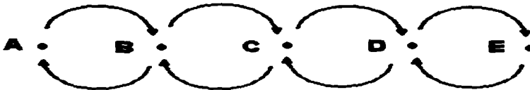
LOOPS DE DOBLE RECORRIDO PARA LIGAR LAS ESTACIONES SELECCIONADAS DE CADA PROSPECTO (A B C D E - E D C B A)
