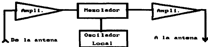
Figura 2.1 Diagrama Simplificado a Bloques de la porción del Radiorepetidor para una típica comunicación por Satélite.
