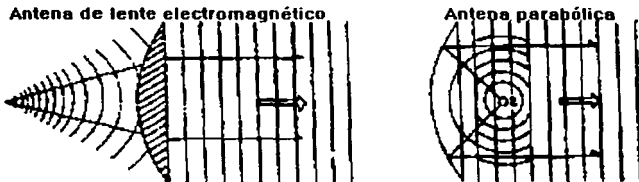
Figura 1.4 Antenas para microondas.
