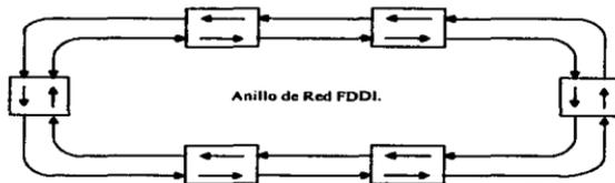
Red FDDI que interconecta seis computadoras con fibras ópticas. Las flechas muestran la dirección del tráfico en las fibras y a través de las computadoras conectadas.
