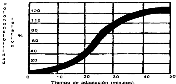
FIGURA 1.5 Curva de la fotosensibilidad relativa del ojo.
