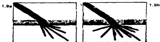
FIGURA 1.9 Transmisión semidirigida y semidifusa.
