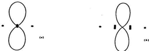
Figura II.6. (a) Arreglo binomial con amplitudes de fuente 1:2:1; (b) arreglo binomial con amplitudes de fuente 1:3:3:1. El espacio entre las fuentes es media longitud de onda.
