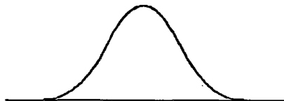
Figura 4.12. Curva normal de distribución de frecuencias de una medida cuando las diferencias son debidas a causas al azar
